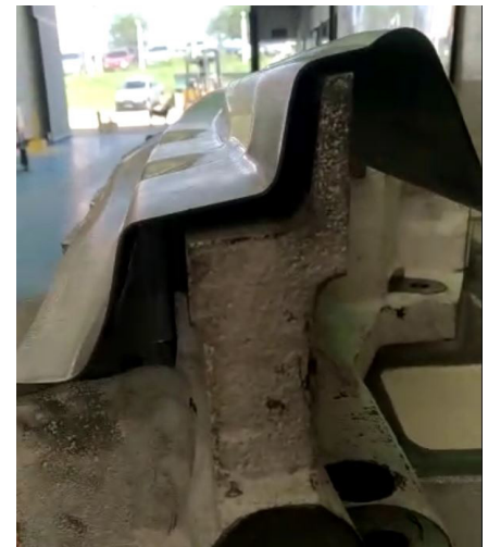
Figura 1: Falha de assentamento em ferramenta de recortar após repuxo.
