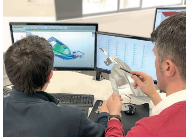
Bild 4: Die AutoForm-Software ermöglicht es den EPALFER-Experten, den gesamten Umformprozess zu simulieren und zu bewerten. AutoForm hat sich als der richtige Partner für EPALFER erwiesen, um seine Ziele zu erreichen.
