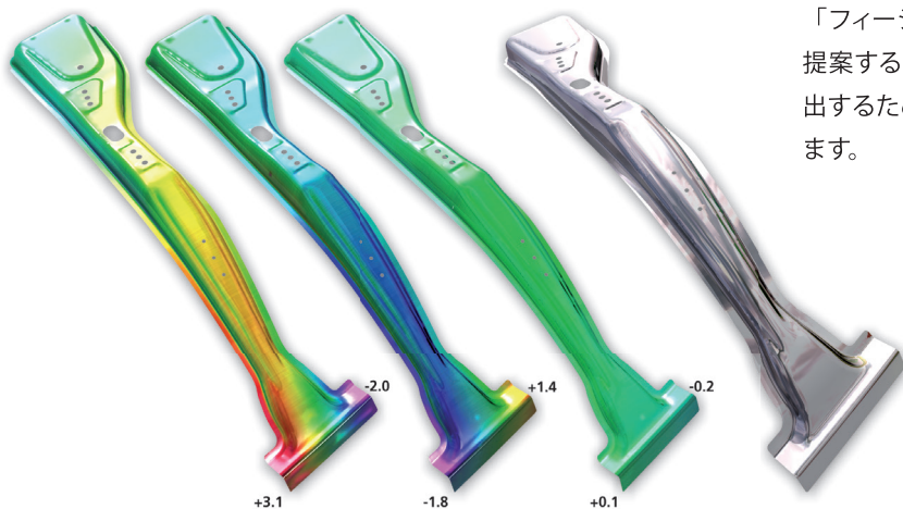
高強度材が自動車部品に採用されるようになり、より顕著化したスプリングバックに対応するため、Walker Tool and Die社では、シミュレーション・ソフトウェアを活用しています。左側の上から3つの画像は、自動車のBピラーの連続的な成形シミュレーションの反復によって、スプリングバックがどのように見込み補正されるかを示し、右側の画像が最終部品を示しています。
