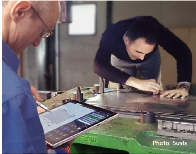
Evaluación de la configuración de matrices utilizando AutoForm-TryoutAssistant en una troquelería
